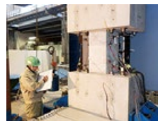
柱増打ち補強工法の 構造性能実験
