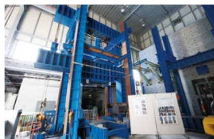
構造実験用フレーム
